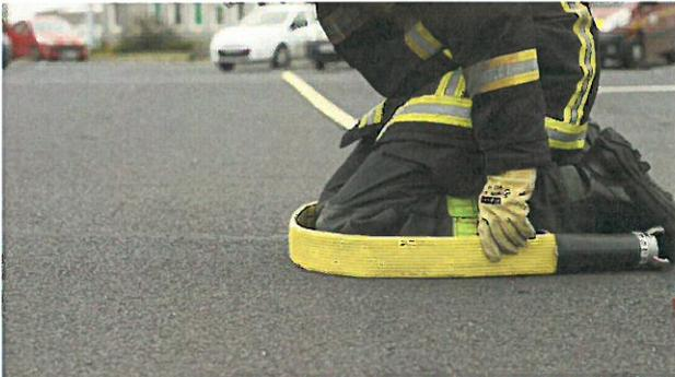
Prendre la mesure du tuyau comme pour le pliage en "Z" en plaçant le demi-raccord au niveau de la cheville
