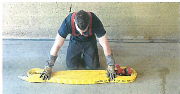
Connecter la LDV (position fermée) et refermer le tuyau. Si le demi-raccord libre est trop court, le mettre à l'intérieur du tuyau.
