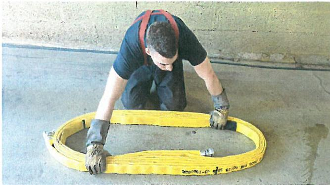
En fin de pliage, ouvrir et faire pivoter l'ensemble du tuyau pour créer un espace pour la LDV.
