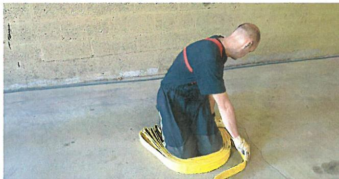
Répéter jusqu'au pliage complet en réalisant des boucles de même longueur.
