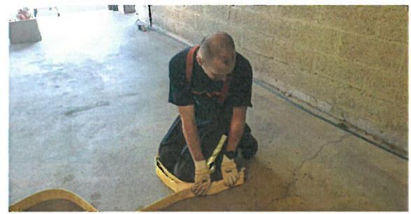
Réaliser une première boucle et en la maintenant, repartir en sens inverse jusqu'à la virole du demi-raccord.
