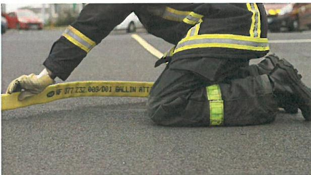
Réaliser une première boucle en faisant glisser le demi-raccord vers l'intérieur du tuyau
